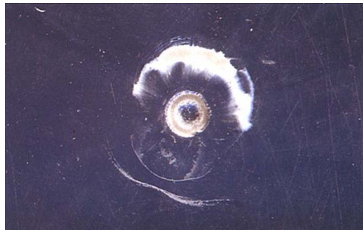
图 58: 熔合纹后的冷料
